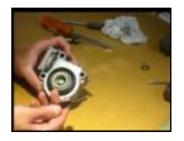
Separar la parte eléctrica de la mecánica que va unida con 4 tornillos de torx.
