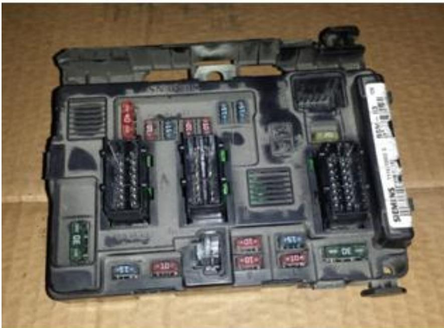
La unidad PSF a parte de ubicar los fusibles lleva integrado el relé de la bomba de combustible, que en este caso es el que no se activa.
