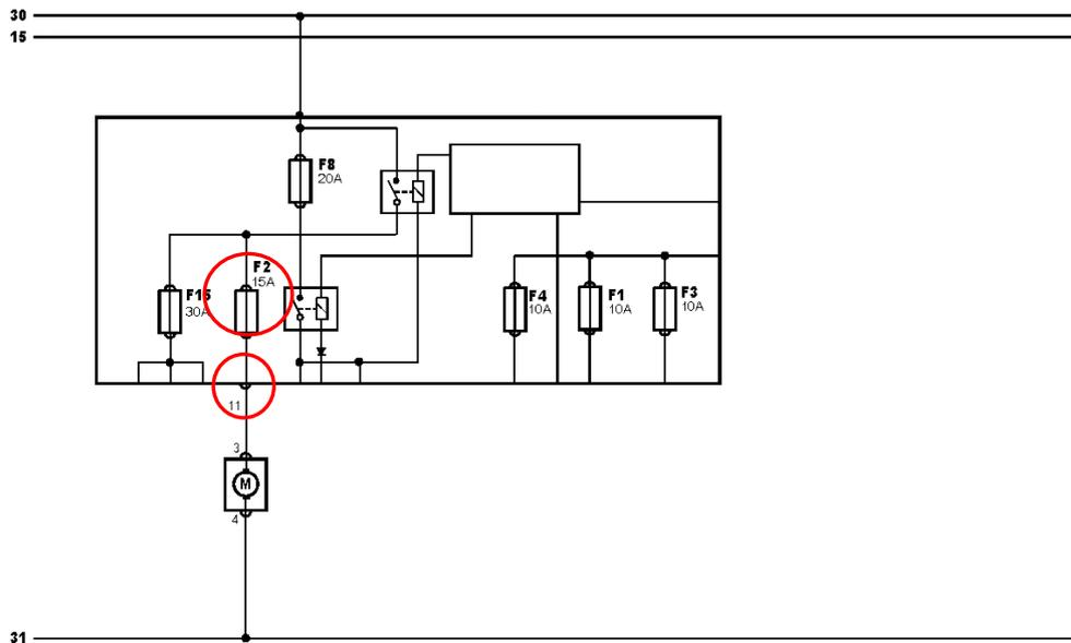
Comprobar alimentación del fusible 2 de 15 amperios, cuyo voltaje debe de 12 voltios
