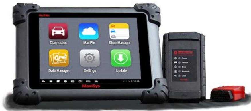
Se realiza un “QuickScan” (Escaneo rápido de todas las unidades de control a través de la unidad de pasarela, tiempo máximo 20 segundos), informando de las averías almacenadas en todas las unidades y detectando dos en gestión motor.
