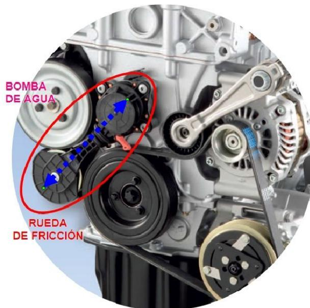
En la primera inspección se observa que la rueda de fricción está actuando con el motor frío y sin recibir positivo de activación.
