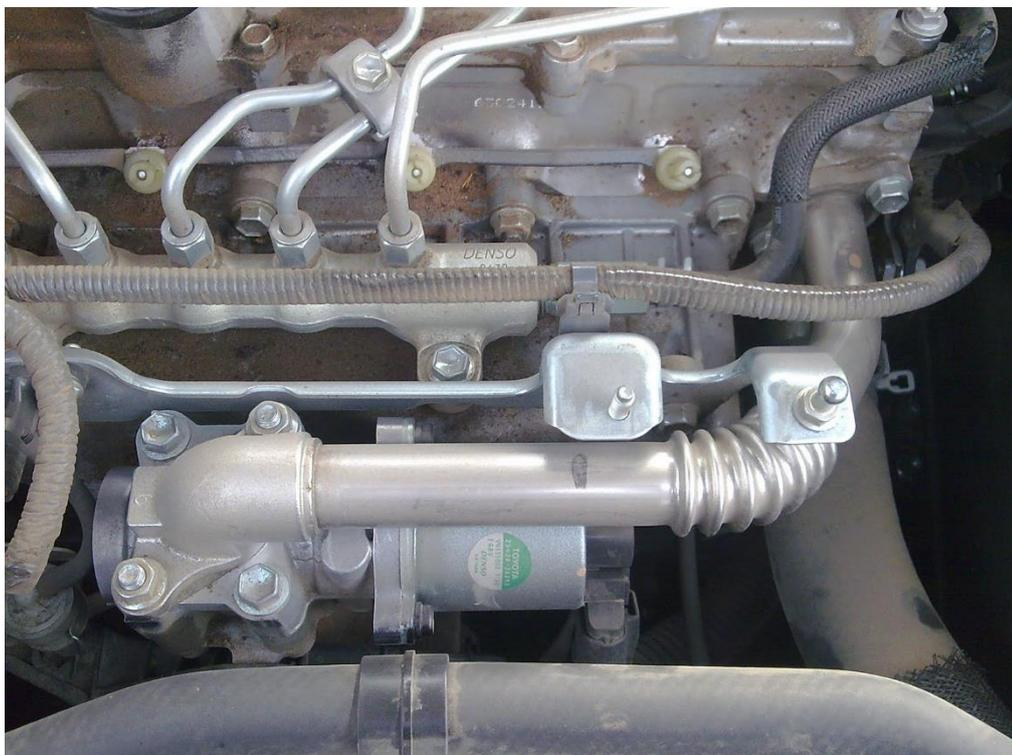
Con la EGR desmontada, tenemos acceso a la boca de entrada del colector de admisión, limpiar y aspirar todos los residuos solidos que podamos.
