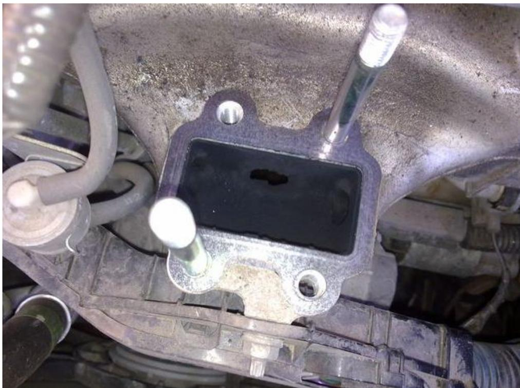
Desarmamos el conjunto de la EGR quitando los tres tornillos de Allen y separamos el motor eléctrico de la parte mecánica.
