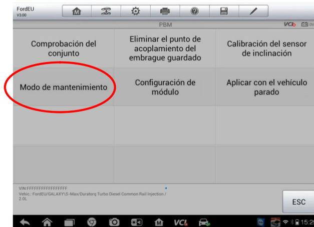
Una vez hemos puesto el modo mantenimiento podemos sustituir las pastillas traseras. Una vez sustituidas, hay que volver a activar el sistema, para activarlo, hay que seguir este sistema manual:
