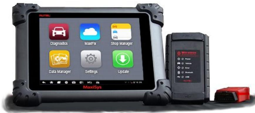
Se realiza diagnostico con equipo Autel con DTC.
