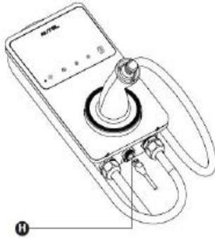
1. El MaxiCharger se puede conectar a Internet tanto por conexión Ethernet como por tarjeta SIM.
