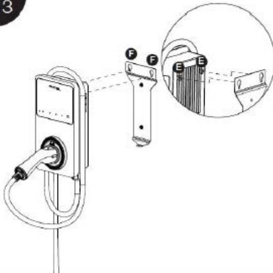
Monte la unidad principal en el soporte de pared introduciendo los dos tornillos salientes (E) de la parte trasera de la unidad principal en los dos orificios de montaje superiores (F), y luego deslice la unidad principal hacia abajo.
